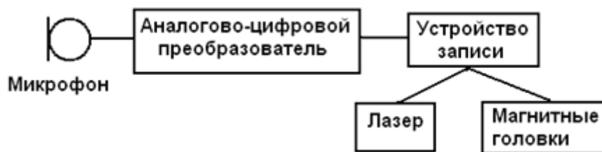
Рис. 5. Схема цифрового способа записи звукового сигнала
