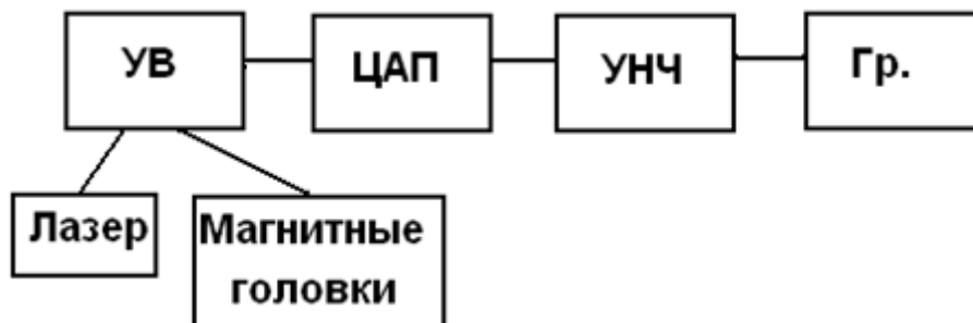
Рис. 6. Схема цифрового способа воспроизведения звука
