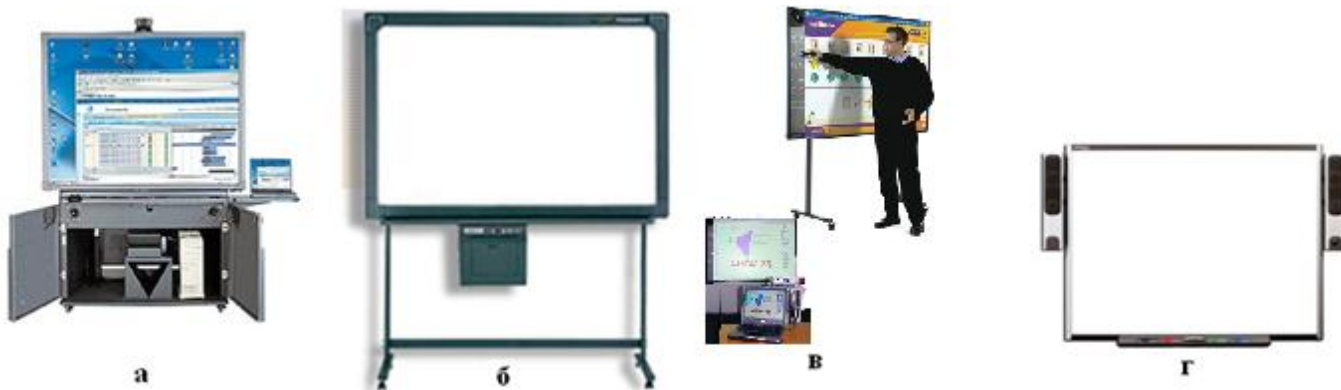
Рис. 15. Модели интерактивных досок с проекцией на ЖКИ панель (а) и внешний экран-доску (б, в, г).
