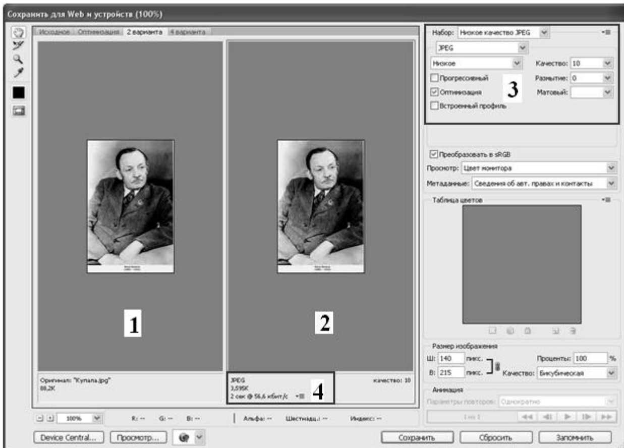
Рис. 22. Оригинал (слева) и конечный файл для веб-страницы (справа) : 1 – оригинал; 2 – фото для веб; 3 – параметры сжатия; 4- параметры сжатого изображения.
