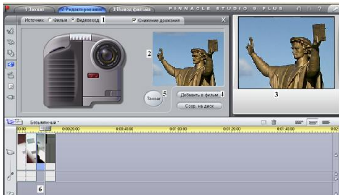
Рис. 5. Захват кадра с видеовхода (камеры): 1- выбор источника захвата; 2 – окно просмотра захватываемого кадра; 3 – окно монитора; 4- кнопка добавления выбранного файла в фильм; 5 – выбор кадра для захвата; 6 – кадр, вставленный в видеоряд монтажной линейки в результате захвата.
