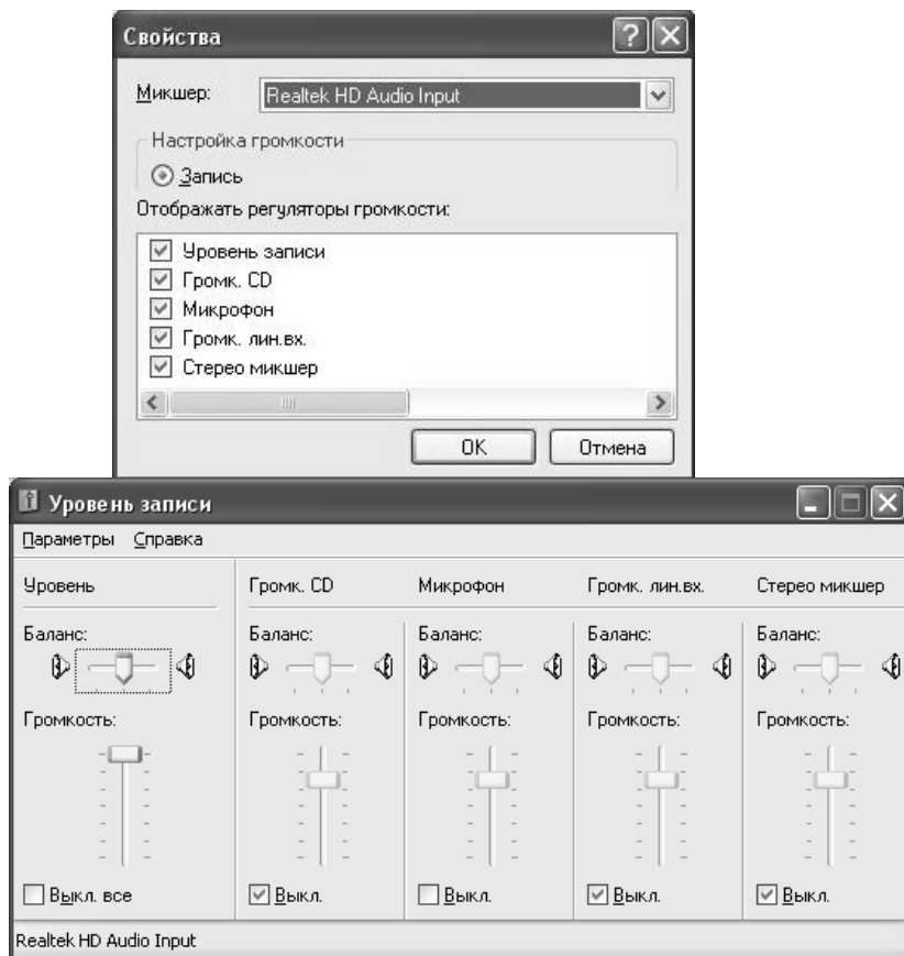
Рис. 2. Переключение в окно свойств (слева), окно регулятора уровня записи в режиме записи с микрофона «Микшер» (рис. 2) используется для записи сигнала со звуковой карты компьютера, линейный вход – от музыкального центра. «Микрофон», «Линейный вход» и «Сtereo микшер» включаем поочередно только на время записи от этого источника.
