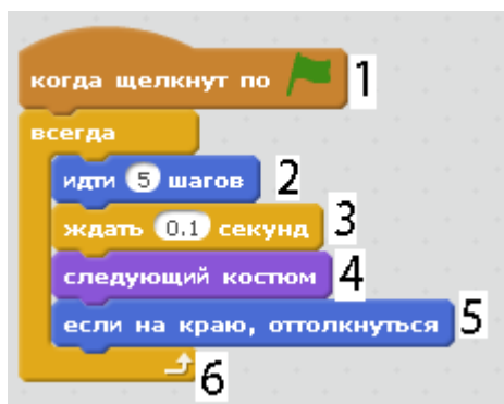
Рис. 1. Программа для кота: 1 – запуск программы; 2 – вкладка «Движение»; 3 – вкладка Управление; 4 - вкладка Внешность; 5 – Движение; 6 - Управление
